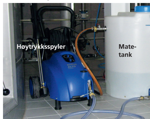
Bruk av pH-nøytrale rengjøringsmidler ved hjelp av høytrykksspyler
